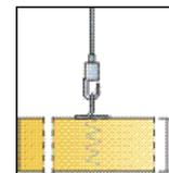
Потолочная система состоит из акустических свободновиисящих элементов Ecophon Solo Circle, изготовленных из стекловолокна, размером  $\varnothing 1600 \times 40$  мм, устанавливаемых горизонтально. Вес системы примерно 8 кг. При монтаже панелей применяются следующие элементы: главные направляющие Connect T24, спиральный анкер Connect и регулируемые тросиковые подвесы Connect.
